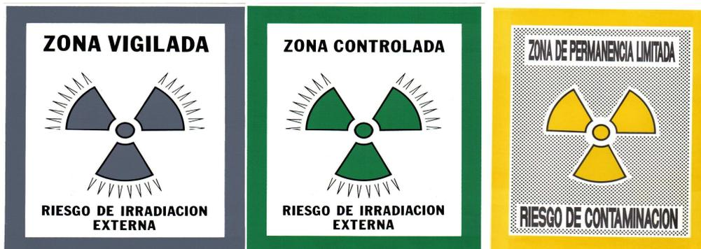
*Figura 2: Trisectores de zona vigilada y controlada con riesgo de irradiación externa y de zona de permanencia limitada con riesgo de contaminación, como reza en las leyendas.*
