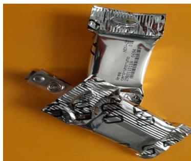
*Figura 1: Modelo de dosímetro personal de solapa del CND.*
